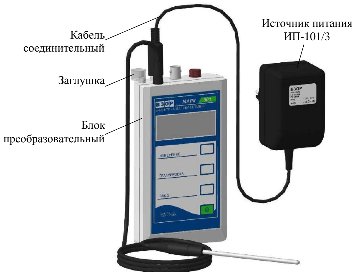
Рисунок 3.1 – Зарядка аккумуляторных батарей
