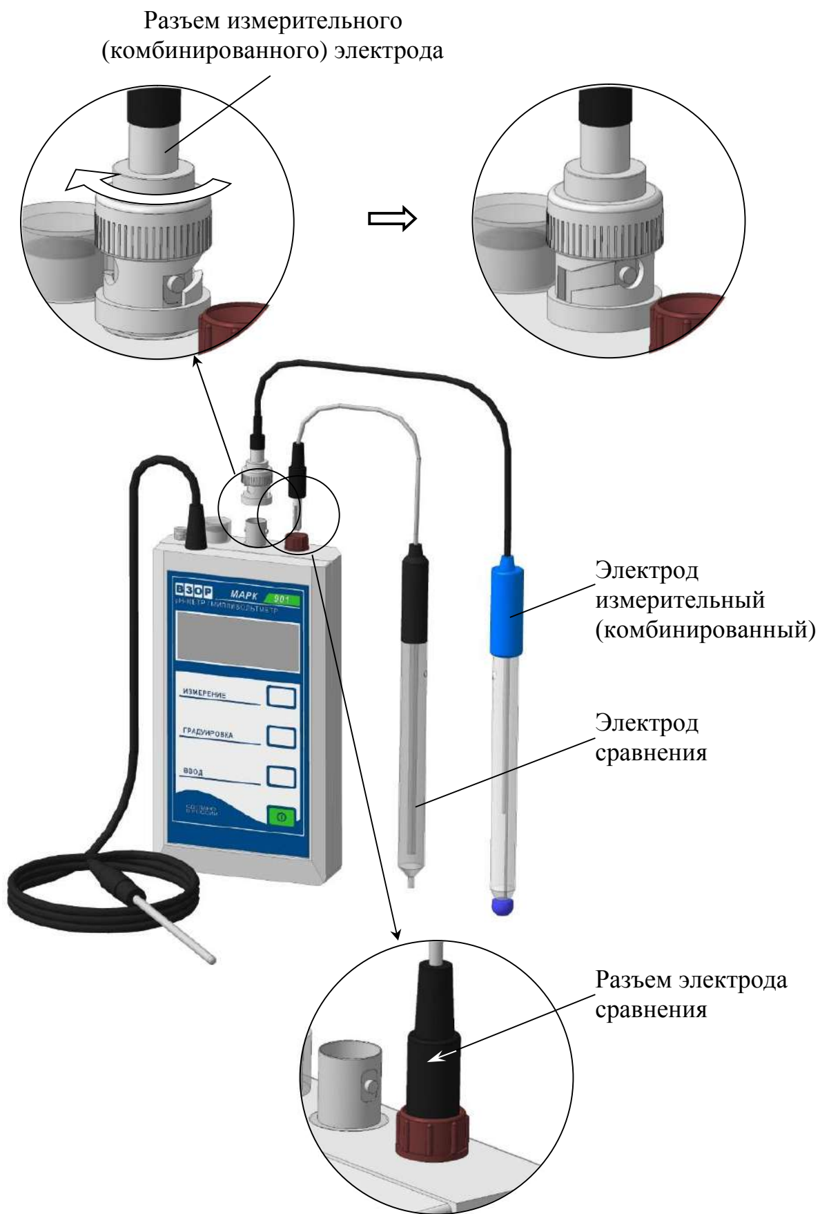
Рисунок 2.4 – Установка электродов
